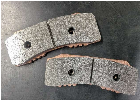
サンスターのローダストブレーキパッドと熱処理廃止鉄製ブレーキディスク
