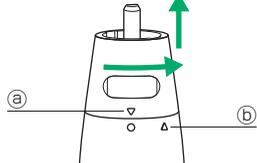
軸カパーを外す場合は、軸カパーにあるママーク④を本体部の△マーク⑤の方向へまわして外します。
