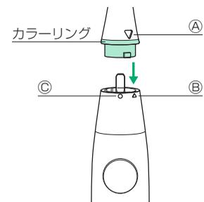
①カラーリング上部のママーク④を軸カパーの△マーク⑤に合わせて溝に押し込みます。
